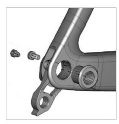
Bitte achten Sie bei der Montage des Schaltauges, auf die korrekte Positionierung des weißen Pfeils, in Bezug auf die obere Fixierungsschraube. Siehe Bild:
