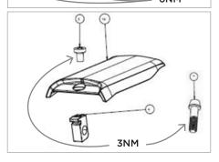
Der Creston iC Vorbau hat eine Abdeckkappe mit integrierten Zugführungen, welche als separates Ersatzteil geordert werden kann.
